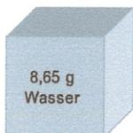
Wird nun diese Luft auf 9,3°C abgekühlt, ist die Wassermenge immer noch 8,65 g, die Luft ist jetzt aber an der Grenze ihres Speichervermögens, das heißt, die relative Luftfeuchte beträgt 100%.
